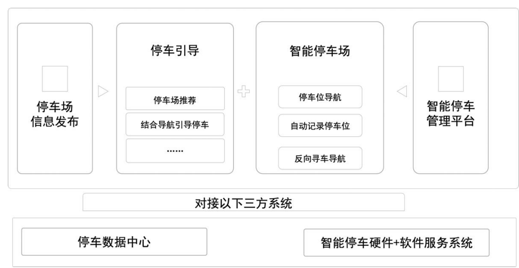
图9 智能停车管理系统整体架构
